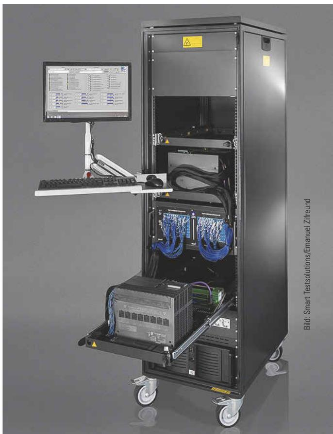
Die Testumgebung für Brennstoffzellensteuerungen – in diesem Fall eine Siemens Simatic S7 – simuliert alle relevanten Betriebsparameter
